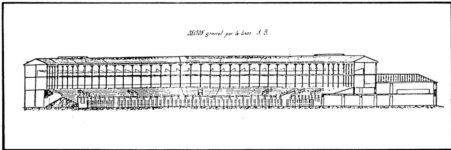
**Fig. 33. Alzado interior de la plaza según el primitivo proyecto de Fenech-Martín. Los dos pisos de gradas en la realidad quedaron reducidos a una sola planta. (A.M.T.).**
