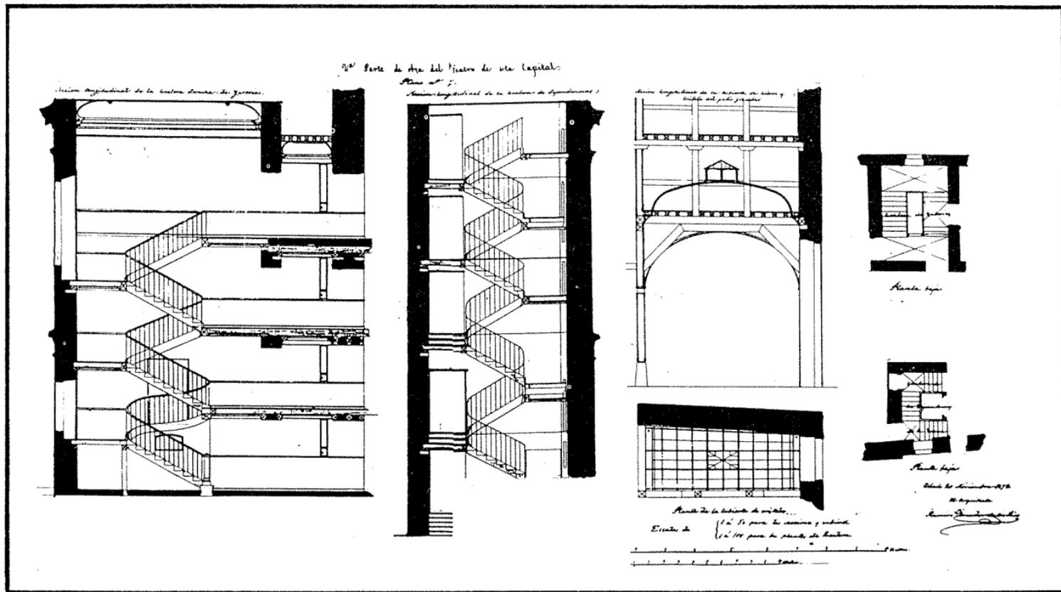
Fig. 20. Alzados de las escaleras y sistemas de entramados. Proyecto de Amador de los Ríos, 1870. (A.M.T.).
