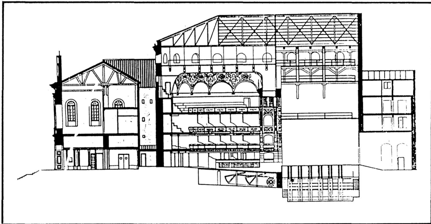
Fig. 17. Alzado interior del Teatro Rojas. Dibujo de la Arquitectura teatral en España, en 1985 según Rodríguez Noriega y Tuñón Alvarez. Aunque el dibujo sea actual se puede observar la disposición de los volúmenes y su proporción que es básicamente la misma que la diseñada por Amador de los Ríos en 1870.
